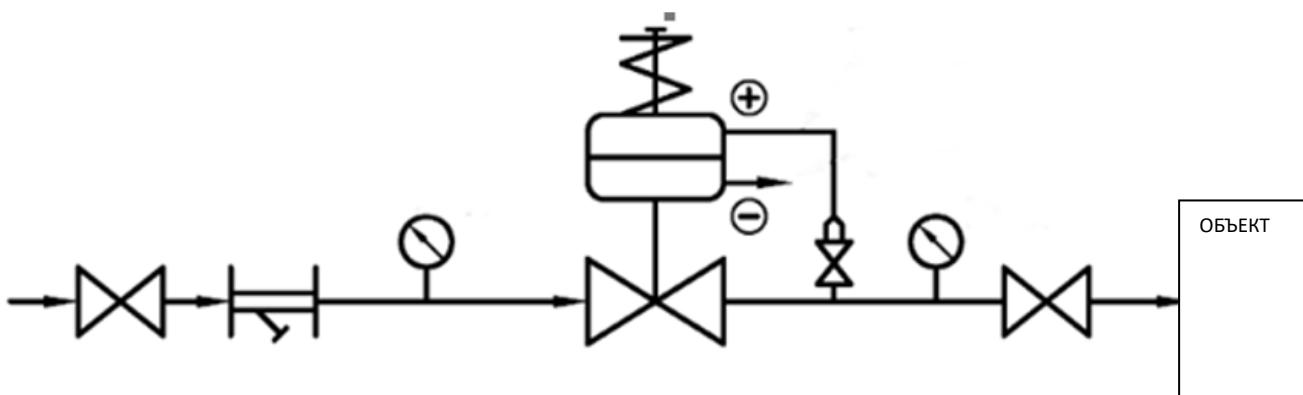
Схема подключения регулятора в качестве редуктора давления для исполнения 20.
