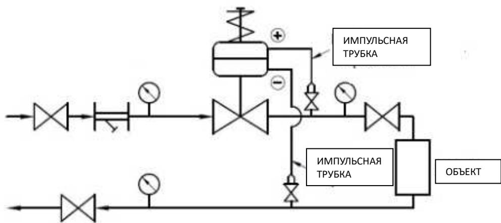
Схема подключения регулятора перепада давления после установки на обратном трубопроводе для исполнения 10.
