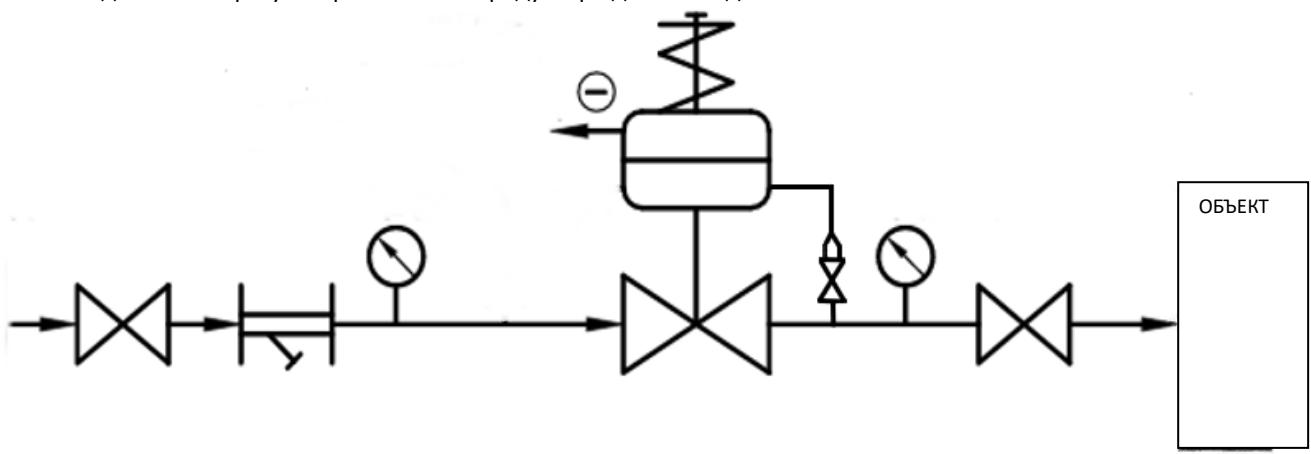
Схема подключения регулятора перепада давления после установки на подающем трубопроводе для исполнения 10.
